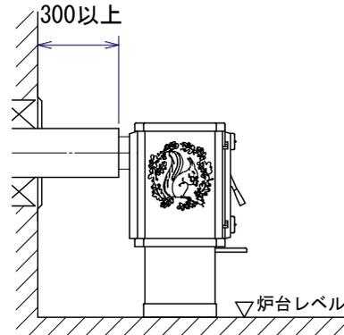
※後方壁抜きは二重断熱煙突に限る。
