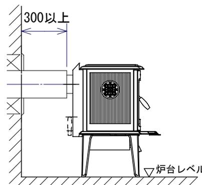
後方壁抜きは二重断熱煙突に限る
