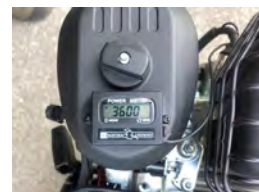
エンジンオイル、油圧オイル等のメンテナンスに有用なアワーメーター付
