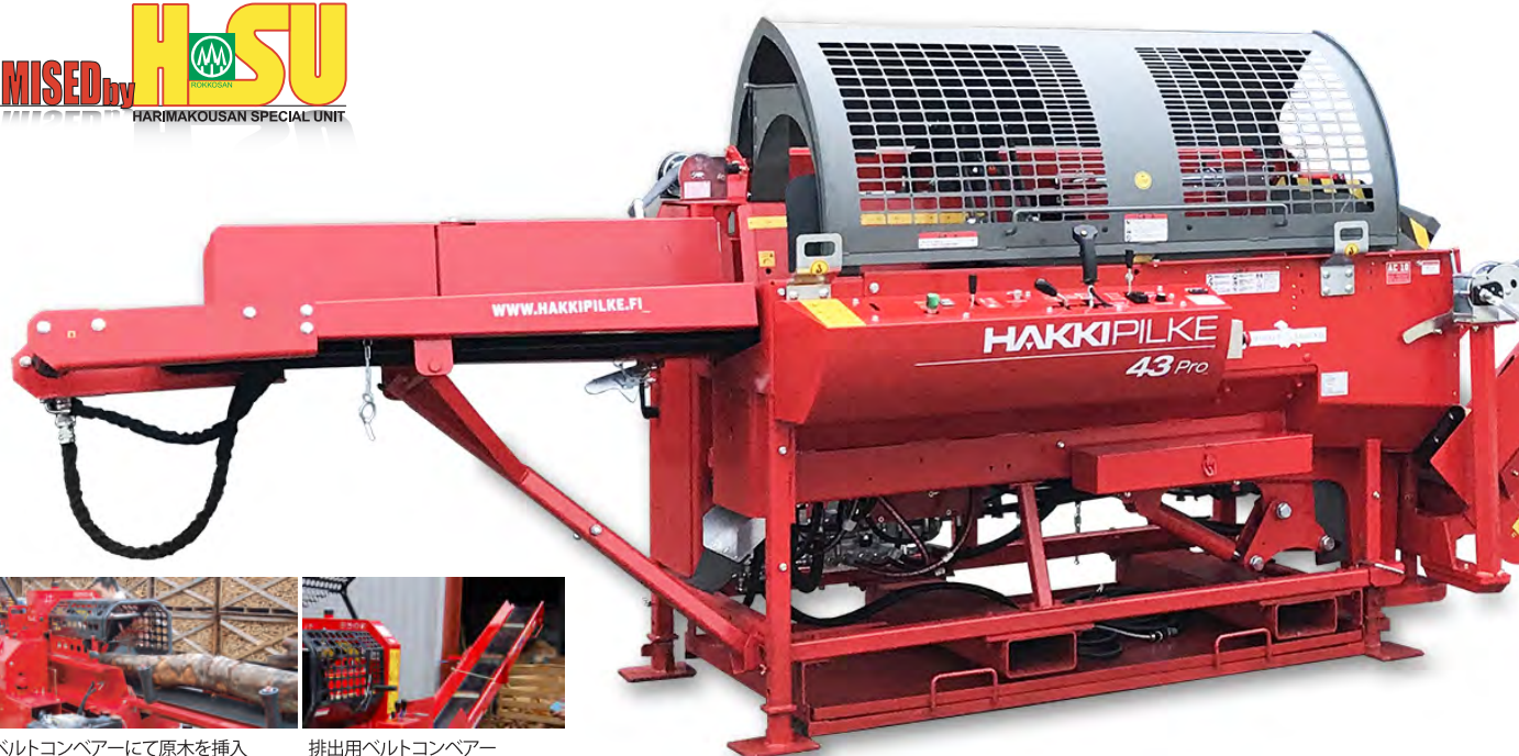
ベルトコンベアーにて原木を挿入
