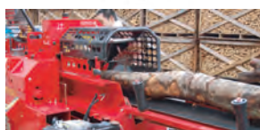
ベルトコンベアーにて原木を挿入
